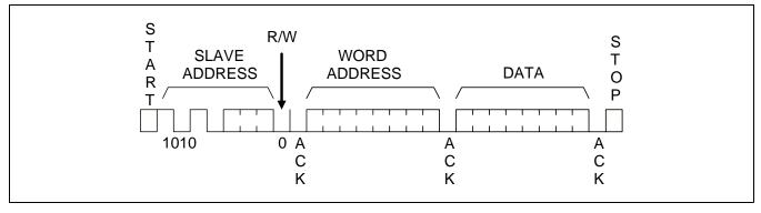
Figure 40. Serial Interface Byte Access-Read
