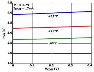
FIGURE 11. ON-RESISTANCE vs SWITCH VOLTAGE
