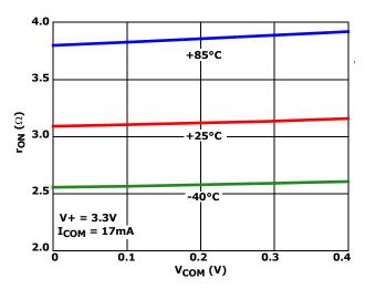
FIGURE 13. ON-RESISTANCE vs SWITCH VOLTAGE
