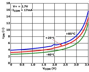
FIGURE 12. ON-RESISTANCE vs SWITCH VOLTAGE
