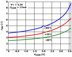
FIGURE 14. ON-RESISTANCE vs SWITCH VOLTAGE
